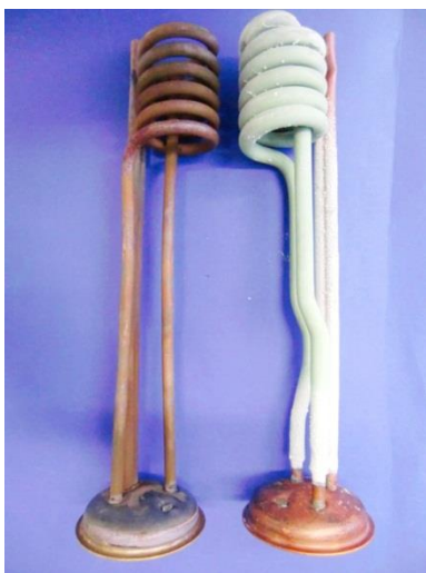
Vergleich einer Heizschlange aus einem Warmwasserboiler, mit (links) und ohne (rechts) Inhibitor-Zugabe
