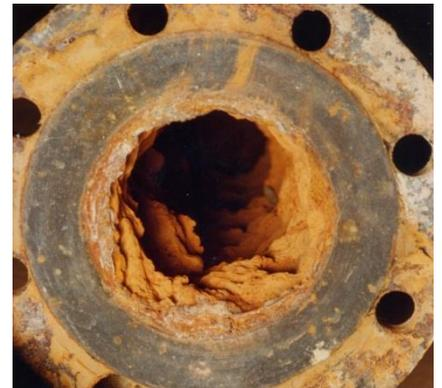
1. Phase: Ca. 6 Monate vor der Umstellung auf weiches Wasser wird das Versorgungssystem mit einer Orthophosphatlösung stabilisiert. Der dosierbedingte Eintrag sollte bei ca. 3 mg/L Phosphat ( $\text{PO}_4$ ) liegen.
