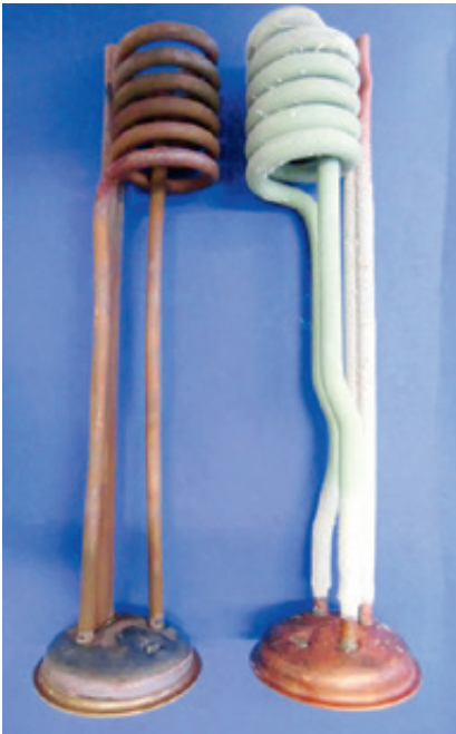
Abb. 3 – Vergleich einer Heizschlange aus einem Warmwasserboiler, mit (links) und ohne (rechts) Inhibitor-Zugabe
